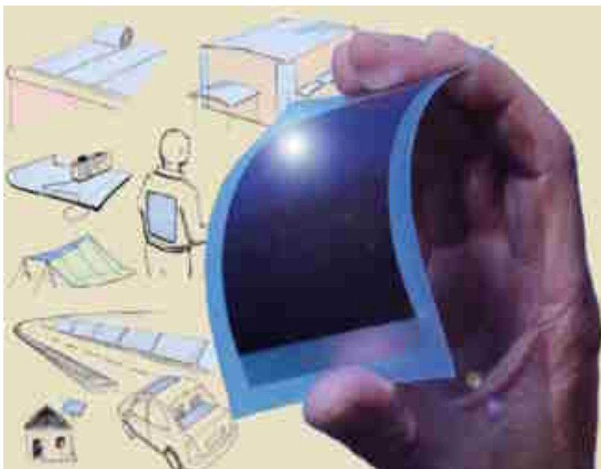
Figuur 41. Flexibele zonnefolie van Nuon (Helianthos). Nuon heeft deze revolutionaire dunne filmtchnologie van Akzo en Shell overgenomen om goedkope en flexibele zonnecellen te produceren, die naar verwachting in 2009 op de markt komen. Deze zonnecellen zijn te lamineren op daken en zouden een integraal onderdeel kunnen gaan vormen van een gebouwde omgeving met eigen gelijkstroomnet. Belangrijk daarvoor is dat de zonnefolie op grote schaal wordt geproduceerd, zodat de kostprijs omlaag gaat en de zonnestroom concurrerend wordt met het lichtnet.
