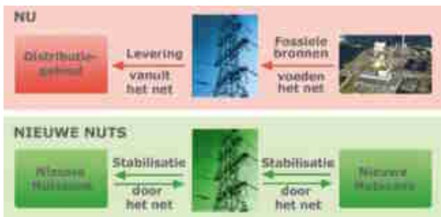
Figuur 12. De rol van het net verschuift van transport naar stabilisatie. Het wordt minder gebruikt om fossiele energie over lange afstanden te transporteren, en meer om lokale tekorten en overschotten aan duurzame energie te verevenen.
