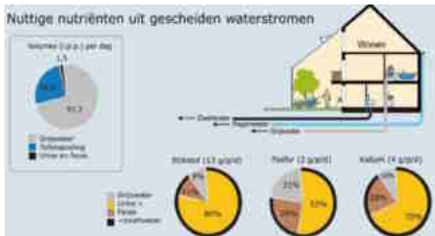
Figuur 23. Nuttige nutriënten uit gescheiden waterstromen. “Zwartwater” bevat het leeuwendeel van de voedingsstoffen (stikstof, fosfor en kalium) in huishoudelijk afvalwater. Op de totale afvalwaterstroom bedraagt het aandeel “zwartwater” circa 1 procent. Het is echter verantwoordelijk voor 90 procent van alle stikstof en bijna 80 procent van alle fosfor die in ons afvalwater terecht komt. Bij de rioolwaterzuivering vormen ze een grote zuiveringslast. Door het zwartwater apart in te zamelen en te behandelen, kan het water beter worden gezuiverd en kunnen de nutriënten bovendien nuttig worden gebruikt als bron voor meststoffen. Voor het resterende grijswater ontstaan daarbij ook interessante decentrale zuiveringsopties, bijvoorbeeld met behulp van Nieuwe Nutsnatuur.
