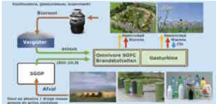
Figuur 28. Schematische weergave van volledige benutting van lokale organische reststromen. Het bioriool voorziet in de af- en aanvoer van vergistbare reststromen. Niet-vergistbare stromen zoals stro en koolzaadschroot worden zover mogelijk in synthesesgas en olie omgezet (SGOP, synthesesgas- en olieproductie). Gesorteerde plastics kunnen ook voor verolieging in aanmerking komen. De reststromen voeden de combinatie van hete brandstofcel (SOFC) met gasturbine (zie hoofdstuk 8). De CO 2 wordt toegepast in gesloten tuinbouwkassen.
